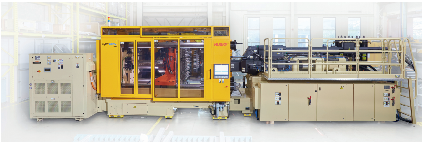
Das RMTP-Modul von Husky wird als Ergänzung für das bewährte Hochleistungssystem HyPET HPP5e angeboten. © Husky
